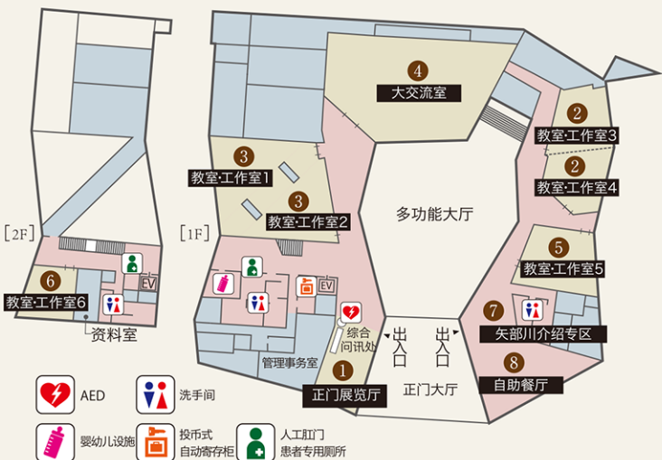
3 教室·工作室1、2 移动隔板可以将两个房间变成一个可 回游式的整体房间。
